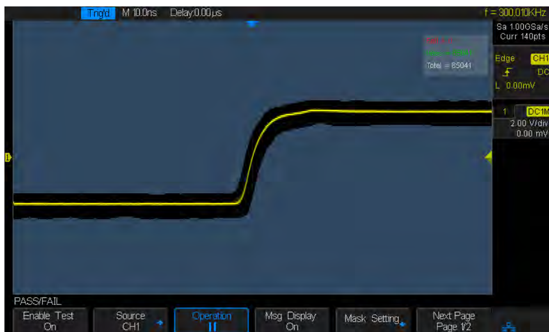
Figure 79 Test bon / mauvais
